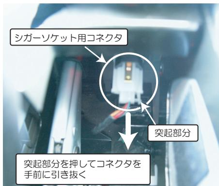
左写真のシガーソケット用コネクタ（白いコネクタ）の右手にある突起を押さえ、手前に引き抜いてください。
