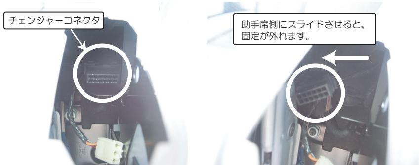
5) ダミーコネクタを取り外します。下記左図を参考にダミーコネクタを外してください。
