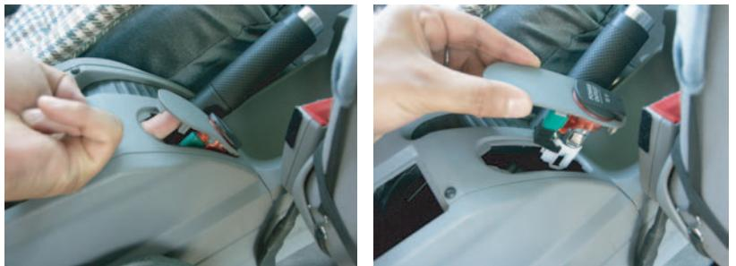
4) . CDチェンジャーデータケーブルのコネクタ（以下“チェンジャーコネクタ”）は固定されています。下記写真のようにチェンジャーコネクタを“助手席側”にスライドさせて、固定を外してください。
